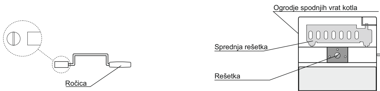
Slika 11. Sprednja rešetka in orodje za dvigovanje rešetke
