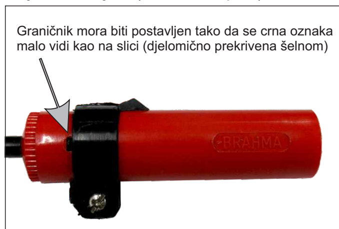
Slika 3. Pažljivo postavite fotoćeliju u nosač na kutijici do graničnika
